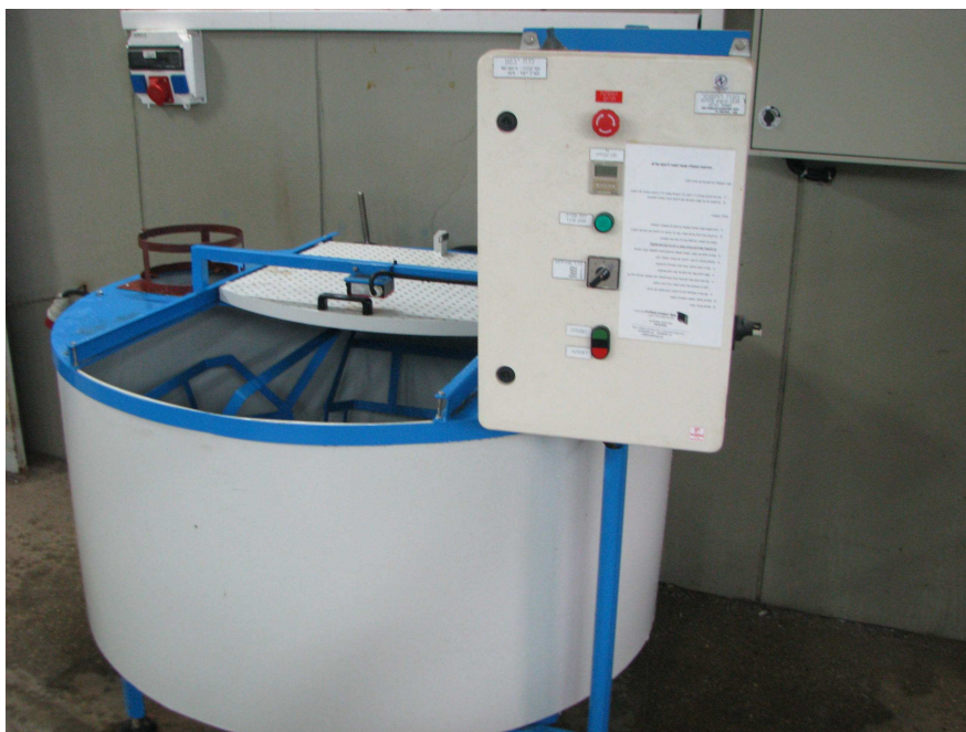
תמונה 1 : צנטריפוגה לייבוש תבלינים. ניתן ליבש ארבעה ארגזי שדה.
